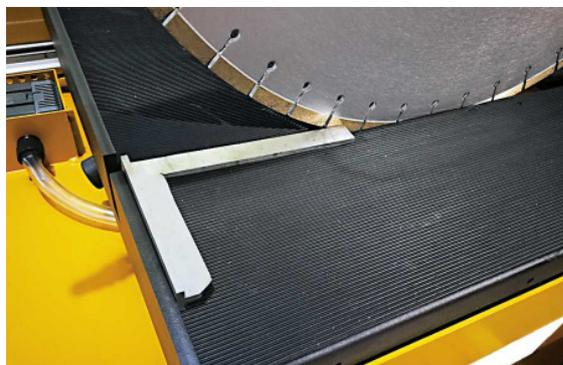
Abb. 10 Sägeblatt 90° Winkel prüfen
