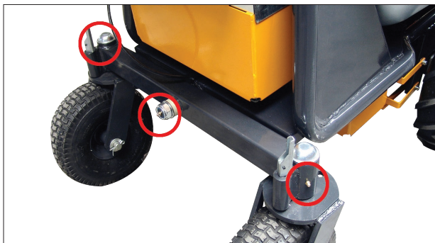
Die Drehpunkte der Pendelachse alle 80 Betriebsstunden nachschmieren.
