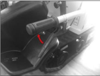
Abb.1 Kippgriff mit Sicherungshebel
