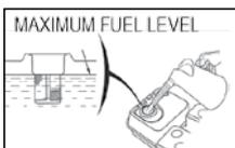
Für diesen Motor ist ausschließlich bleifreies Normalbenzin mit einer Oktanzahl von 95 oder höher erforderlich. Verwenden Sie nur frischen, sauberen Kraftstoff. Wasser oder Unreinheiten im Benzin beschädigen das Kraftstoffsystem.
